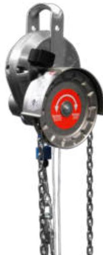
IKAR-Höhensicherungsgerät mit Rettungshubeinrichtung und Haspelkette, die spezielle Alternative für jeden Einsatzort. Die Haspelkette ermöglicht eine problemlose Benutzung der Winde des HRA-Gerätes, auch wenn der Anschlagpunkt des Gerätes sehr hoch gelegen ist.
