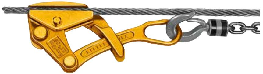
Die LMG Seilklemme ist ein Anschlagmittel zum Greifen, Ziehen und Spannen von nicht ummantelten Drahtseilen, Kabeln und Metallstangen aller Art, in Abhängigkeit von Seildurchmesser und Oberflächenbeschaffenheit, bis zu einer Materialfestigkeit von maximal 1.770 N/mm<sup>2</sup>. Parallele Klemmbacken geben einen rutschfesten Halt, ohne das Seil zu beschädigen. Eine spezielle Führung verhindert einerseits ein Herabfallen der Klemme vom Seil und ermöglicht andererseits sofortiges Lösen.
