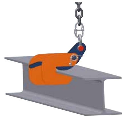
Die horizontalen Hebeklemmen IPBC verfügen über ein Vorspannsystem, mit dessen Hilfe sich die Klemmen zum horizontalen Transportieren und Heben an formstabilem und nicht formstabilem Material befestigen lassen. Diese Klemmen können auch für den Transport von Material verwendet werden, dass in Schneid-, Biege- oder Walzmaschinen und anderen Produktionsanlagen verwendet wird.
