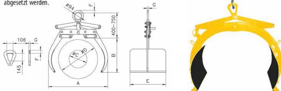
Damit dies bei empfindlichen Oberflächen auch schonend geschieht, können die Greifschalen mit einem Schutzbelag aus Bremsit® oder Hartgummi versehen werden.
